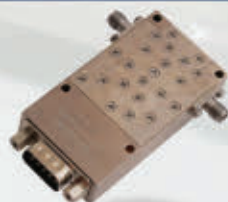
PN: RFDAT0040G5A DIGITAL STEP ATTENUATOR 0.1-40GHz 5 BITS 31dB
